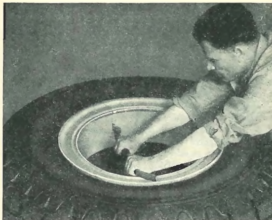
Obr. 138. Uzavření ráčku se provádí ohnutou pákou, kterou lze v případě potřeby (např. při montáži nové obruče) prodloužit rovnou pákou neb trubkou vhodného průměru
