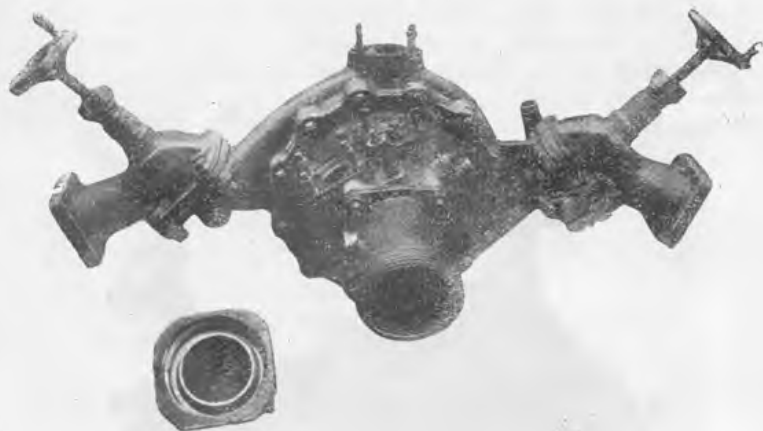
Рис. 90. Центробежный насос ПН-20
