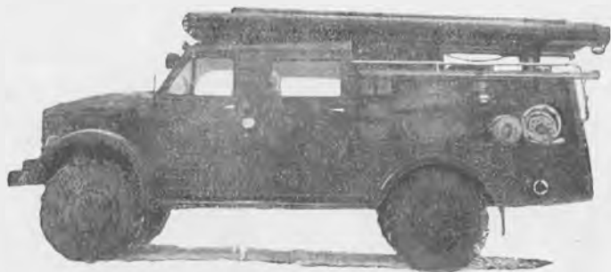
Рис. 2. Размещение противопожарного оборудования на автоцистерне АЦП-20(63). Вид слева
