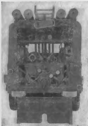
Рис 10 Вид автономного насоса сзади с поднятой шторкой и снятой задней стенкой кузова.
