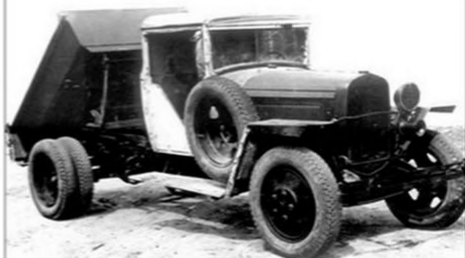
Опытный образец военного самосвала на шасси ГАЗ-ММ появился в 1941 г. и отличался отсутствием боковых дверей и одной фарой
