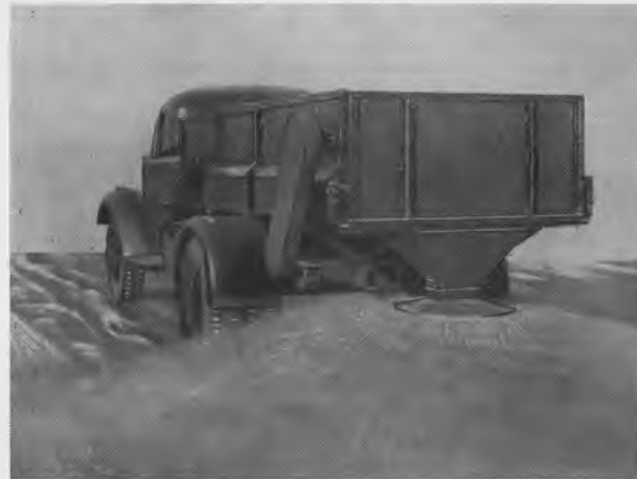
Рис. 37. Посыпка песком дорожного покрытия пескоразбрасывателем ПД-6.
