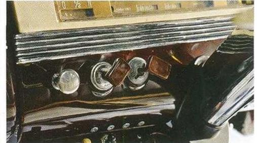
Здесь мы снова наблюдаем наследие донора шасси – «бронированной» машины. Под элегантным щитком приборов установлена неказистая «юбка», на которую вынесена не только кнопка стартера, но и переключатель низковольтной части дублирующего зажигания, а также индикатор температуры масла.
