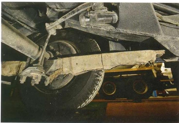
Применение в задней подвеске довольно длинных рессор с большим радиусом изгиба листа положительно сказывается на плавности хода. А для уменьшения трения между листами рессоры смазаны и заключены в плотные чехлы, предотвращающие попадание песка в пары трения.
