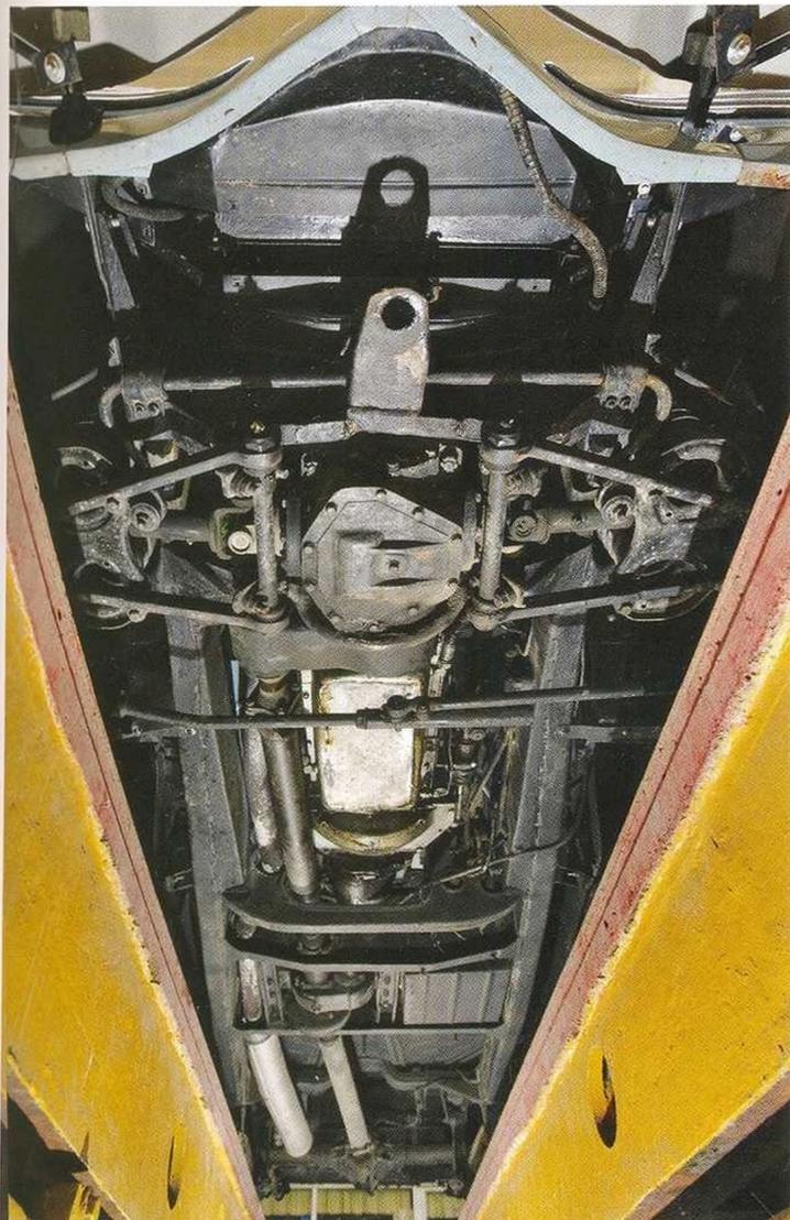
Рама ЗИС-110П весьма существенно отличается от рам ЗИС-110. На «тяжёлом шасси» нет характерных для стандартного «сто десятого» X-образных поперечин с центром в середине базы. А ещё на этом фото видно, что карданные валы находятся в разных плоскостях, что, в свою очередь, требует для обеспечения плавной работы очень сложных расчетов геометрии.
