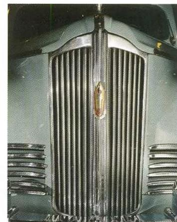
Жалюзи, обычно представляющие собой отдельный блок, на ЗИС - 110 сформированы самой декоративной решёткой. Вертикальные лопасти – поворотные и управляются термостатом автоматически.
