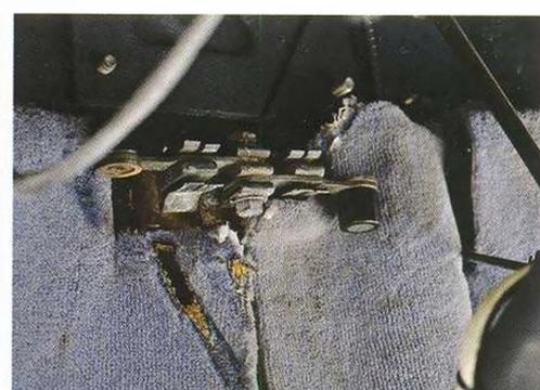
Модели ЗИС - 110П от бронированного ЗИС - 115 досталась и резервная система зажигания (фото слева), переключатель которой установлен под панелью приборов, и вторая система электропитания (фото переключателя справа). Бронированные автомобили оборудовались ими в обязательном порядке, а открытый полноприводный кабриолет получил их «в наследство».
