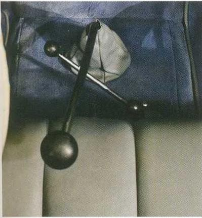
Управление режимами трансмиссии ЗИС-110П возложено на три напольных рычага (у обычного ЗИС-110 рычаг КПП находился на руле). Самый большой – заводит коробкой передач, а два коротких – включают передний мост и демультипликатор. В общем, всё достаточно стандартно. А вот расположение таблички с режимами работы «раздатки» удивило: ей почему-то «нашли место» у лобового стекла, на внутренней поверхности крышки пепельницы!
