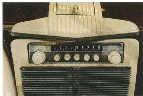
Если часы перед передним пассажиром выполняли скорее декоративную функцию, то приёмнику уделена масса внимания: регулировка тембра заставляла шкалу приёмника менять цвет в зависимости от настроек звука...
