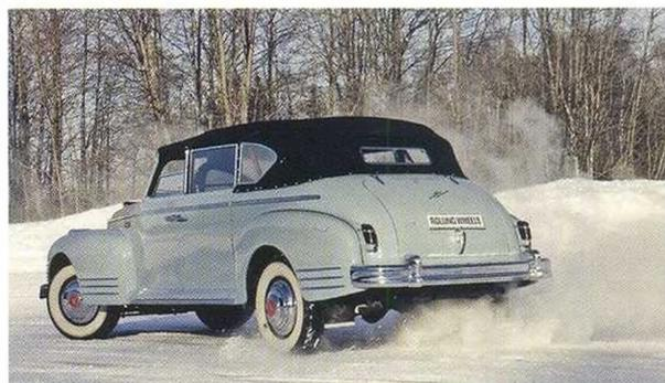
Что же касается заднеприводного режима, то он оказался практически несовместим со скользкой дорогой и высокой скоростью. Срыв в занос ЗИС-110П происходит очень резко. При этом очень «длинный» рулевой привод без гидроусилителя и малые углы поворота колёс не позволяют оперативно «вытащить» машину из заноса. Так что, разворот на 180 градусов почти гарантирован.
