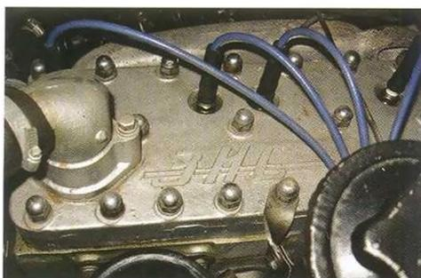
Установленный под капотом ЗИС двигатель «кормя» уходит к моторам Packard и следовательно относится к довоенным нижнеклапаным агрегатам. Но внимание: при этом сами клапаны оборудованы безззорными гидравлическими толкателями (гидрокомпенсаторами).
