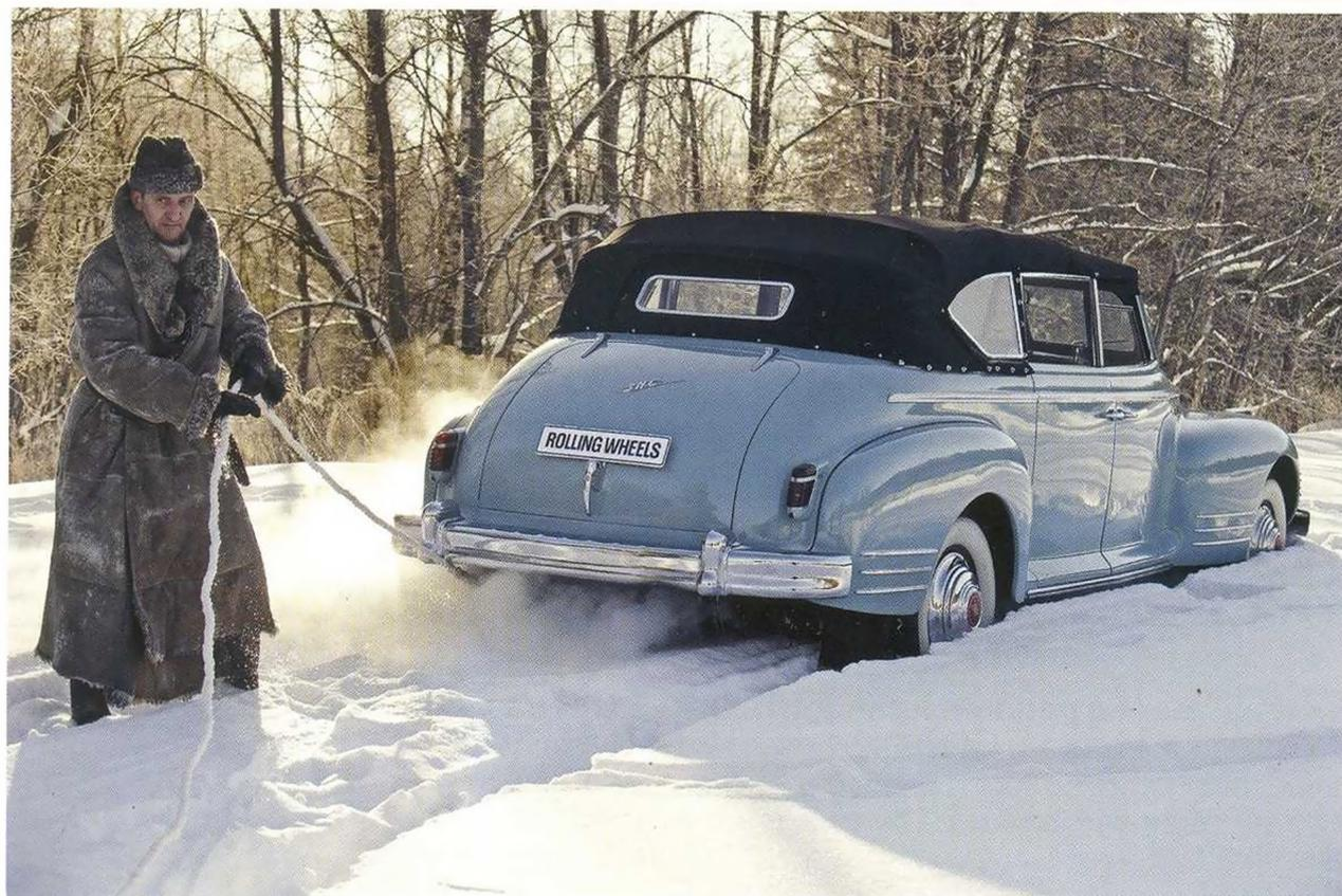
А вот и первая незапланированная остановка... Заехав чуть поглубже в снежную целину, машина просто проломила скрытый под рыхлым слоем снега наст и сразу же «угнездилась». Теоретически можно было бы, продолжая буксовать, в конечном итоге докататься до твёрдого покрытия, но это, во-первых, долго, а во-вторых, не очевидно. Решили «идти в деревню за трактором»...
