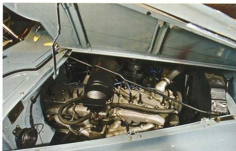
Под капотом ЗИС - 110П установлен шестилитровый двигатель ЗИС - 115 – улучшенная версия мотора ЗИС - 110 (мощность выросла со 140 до 162 л.с.). Кстати, под капотом можно увидеть свидетельство происхождения мотора – надпись «ЗИС» на голове блока расположена в том же месте, что и «Packard» на американском «первоисточнике».
