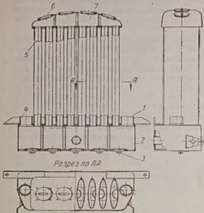
Фиг. 69. Охладитель газа радиаторного типа газогенераторной установки НАМР-Г-78.
