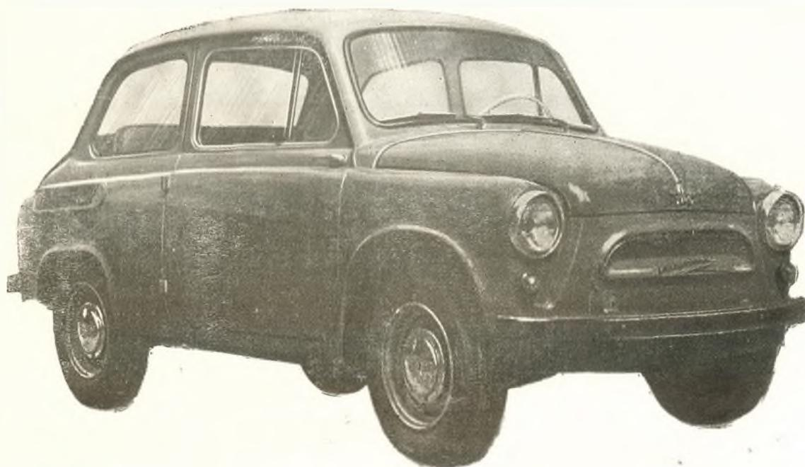
Микролитражный легковой автомобиль с задним расположением двигателя воздушного охлаждения предназначен для эксплуатации в различных климатических условиях по дорогам с усовершенствованным покрытием всех классов. На автомобиле установлен независимый отопитель, обеспечивающий в холодное время года обогрев кузова, обдув ветрового стекла теплым воздухом и подогрев двигателя перед запуском.
