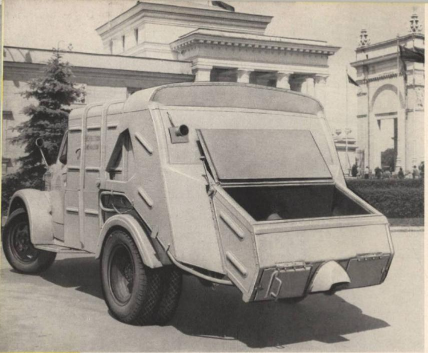
Перемещение мусора из приемного бункера в кузов и его одновременное уплотнение производятся автоматически толкающей плитой с гидравлическим приводом когда закрываются крышка и приемный люк бункера. После уплотнения мусора толкающая плита возвращается в исходное положение. Световые приборы, расположенные в кабине и на задней стенке фургона, обеспечивают постоянный контроль водителя за работой толкающей плиты, наполнением кузова и делают безопасной работу лиц, обслуживающих загрузку кузова.
