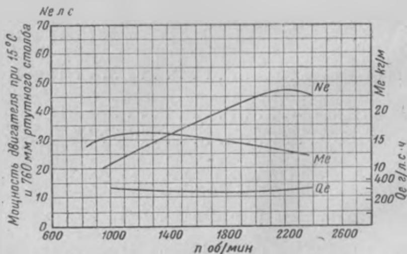
Рис. 3. Характеристика двигателя ГАЗ-АА:
