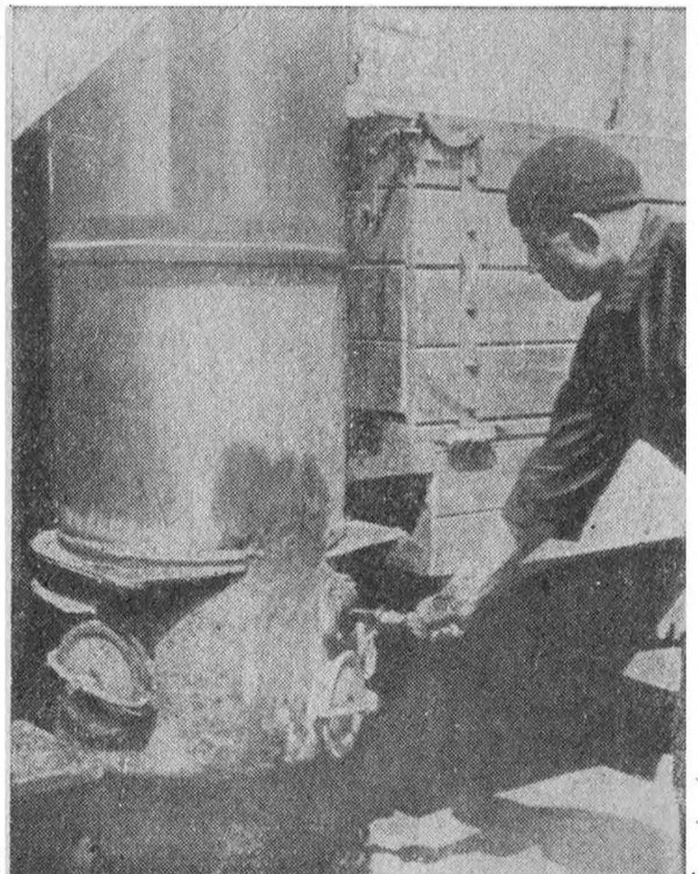
Рис. 27. Розжиг газогенератора.
