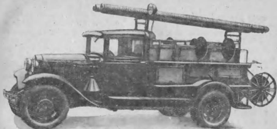
*Рис. 1. Общий вид пожарного автонасоса ГАЗ-А 1.*
