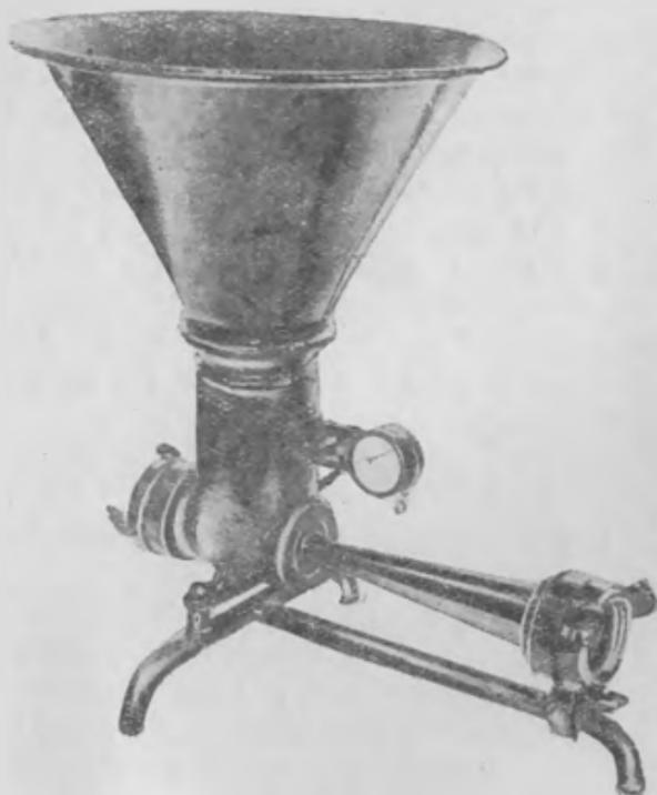
Рис. 21. Пеногенератор высокого давления
