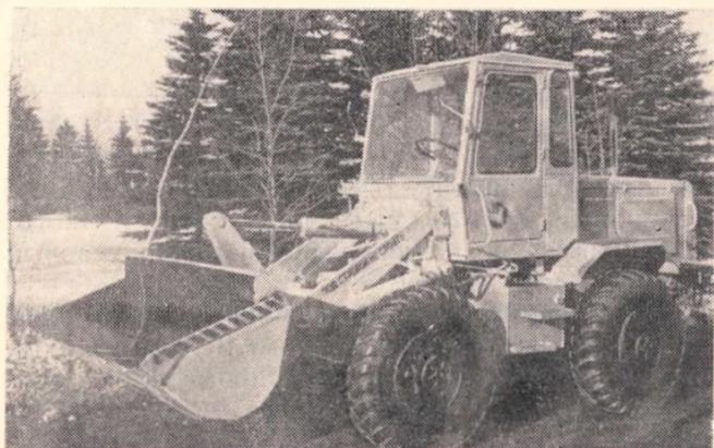
Рис. 1. Одноковшовый фронтальный погрузчик ТО-6А
