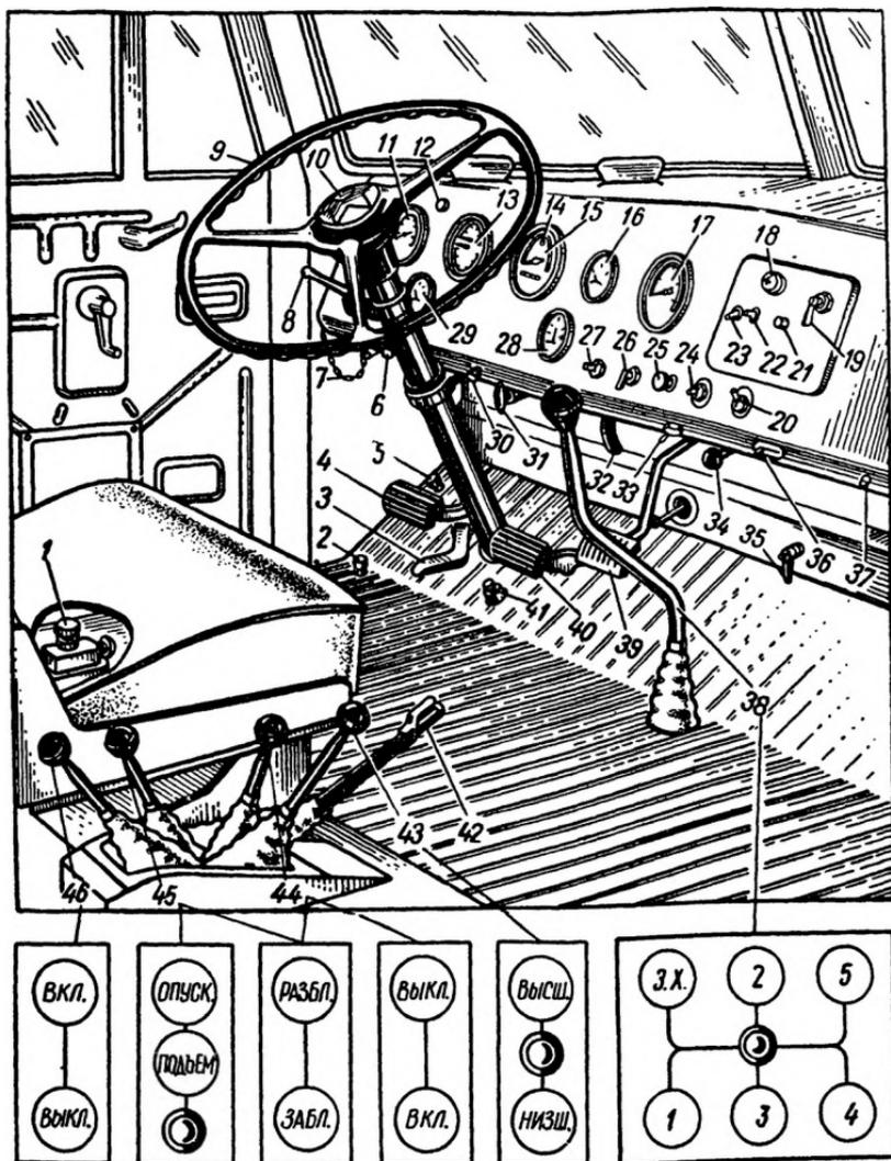
Рис. 7. Органы управления и приборы
