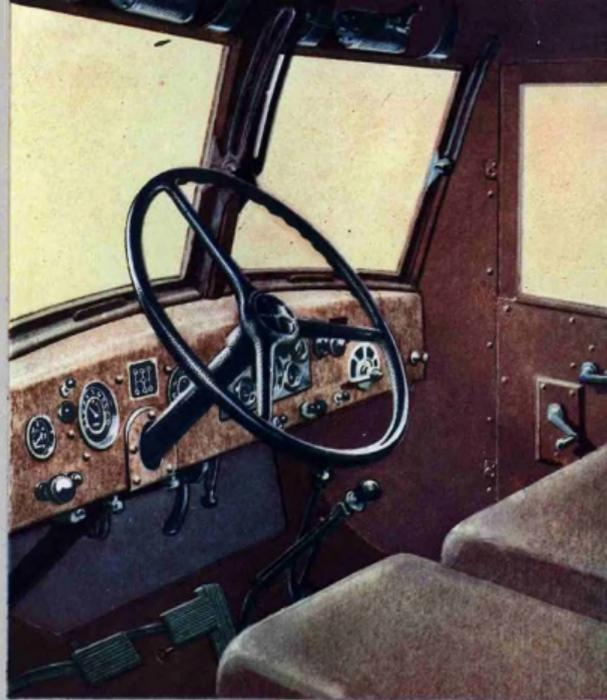
Кабина закрытого типа. Имеет одностороннее сидение для водителя и двухместное для пассажиров. Сидение водителя регулируемое. Стекла дверей можно опускать и поднимать при помощи подъемного механизма. Открывающиеся передние окна снабжены пневматическими стеклоочистителями. Стекло заднего окна защищено решеткой. Кабина оборудована водяным отопителем и вентилятором обдува стекол. При любом морозе в зимних условиях в кабине обеспечивается температура в 18—25° С.
