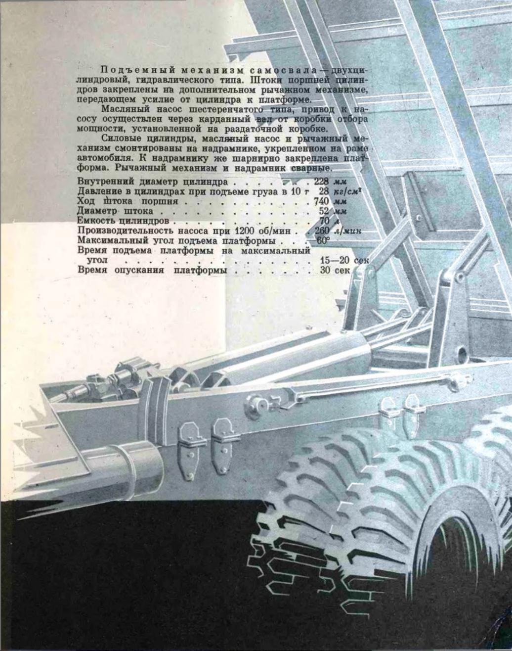
Подъемный механизм самосвала — двухцилиндровый, гидравлического типа. Штоки поршней цилиндров закреплены на дополнительном рычажном механизме, передающем усилие от цилиндра к платформе.
