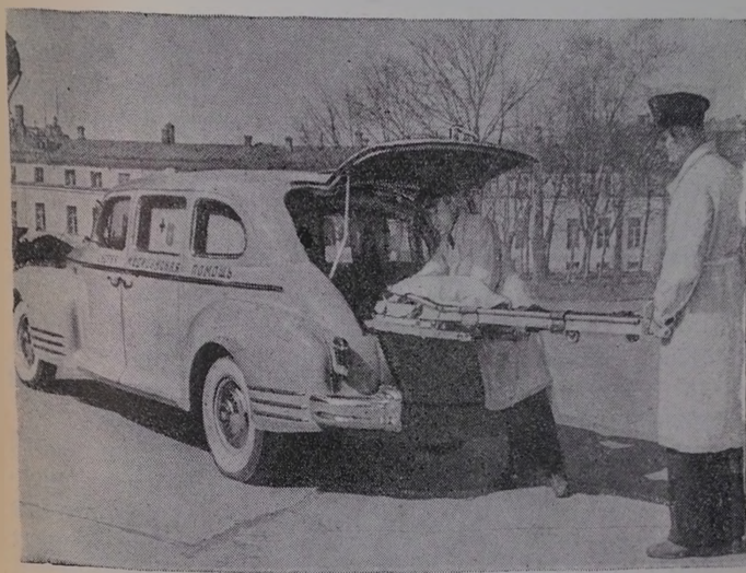
Рис. 14. Установка носилок в машину.
