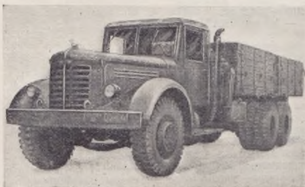
Рис. 1. Трехосный автомобиль ЯАЗ-210 грузоподъемностью 10—12 т.
