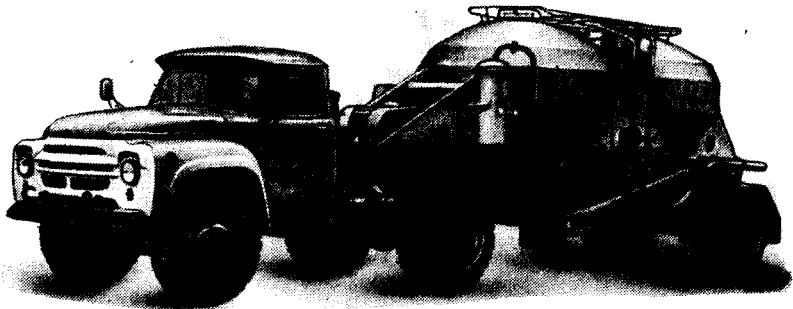
Полуприцеп-муковоз К1040-2Э с тягачом ЗИЛ-130В1
