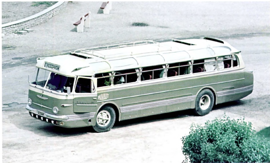
A képen látható Ikarus 55-ös fényszórói már a lökhárító fölé kerültek, de a díszrács még hiányzott (1959)
