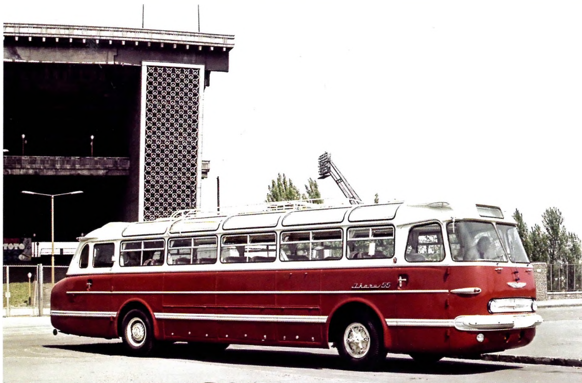
Ikarus 55 típusú autóbusz a „B”-tengely mögé helyezett második utasajtóval (1964)
