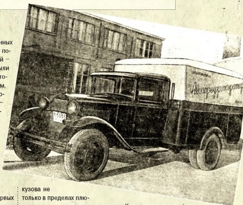
Автомобиль-рефрижератор с пропано-бутановым охлаждением на шасси ГАЗ-АА, 1938 г.
