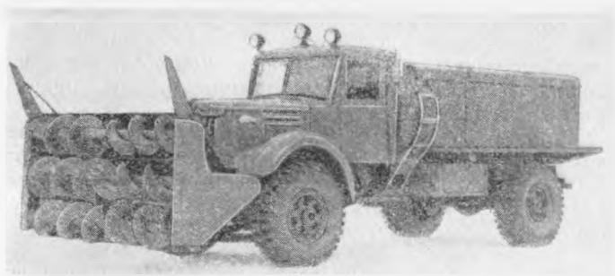
Рис. 142. Шнеко-роторный снегоочиститель Д-450
