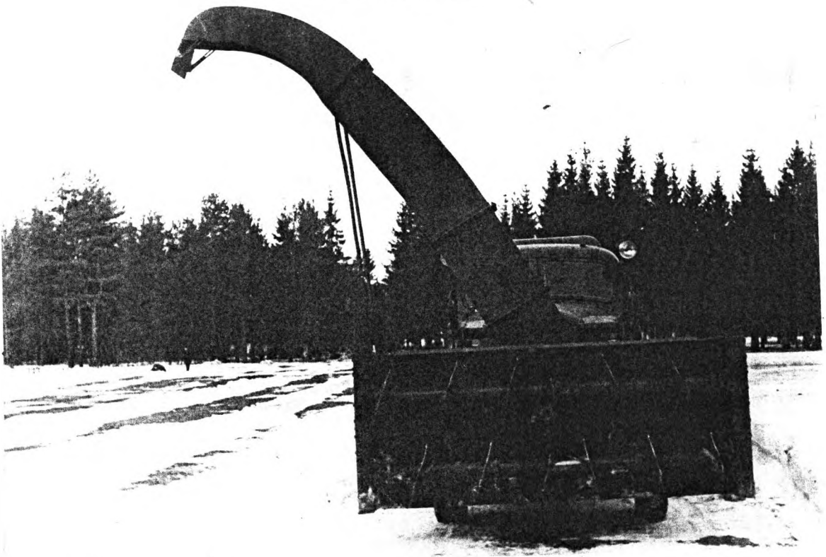
РОТОРНЫЙ СНЕГООЧИСТИТЕЛЬ "Д-262" ВИД СПЕРЕДИ
