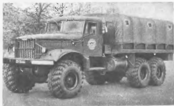
Трехосный грузовик повышенной проходимости КрАЗ-255В с дизелем ЯМЗ-238. С 7,5 тонны груза он весит 19,7 тонны. Его скорость — 55 км/час, а контрольный расход топлива — 38 л на 100 км.
