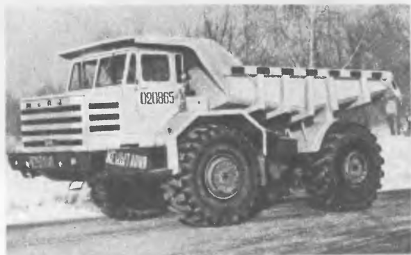
Опытный образец карьерного самосвала МоАЗ-522 снабжен дизелем ЯМЗ-238. Машина рассчитана на перевозку 18 тонн груза, и ее полный вес достигает 35,5 тонны. Скорость — 50 км/час.
