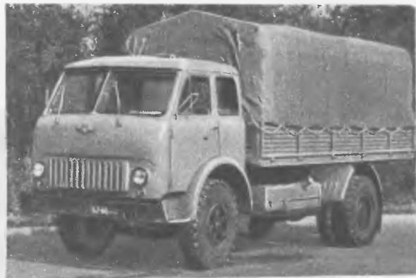
На этом 8-тонном грузовике МАЗ-500, как и на его модификациях (самосвале МАЗ-503, седельном тягаче МАЗ-504 и лесовозе МАЗ-509), установлен дизель ЯМЗ-236. Базовая модель, весящая с полной нагрузкой 14,8 тонны, развивает скорость 85 км/час и имеет контрольный расход топлива 22 л на 100 км.
