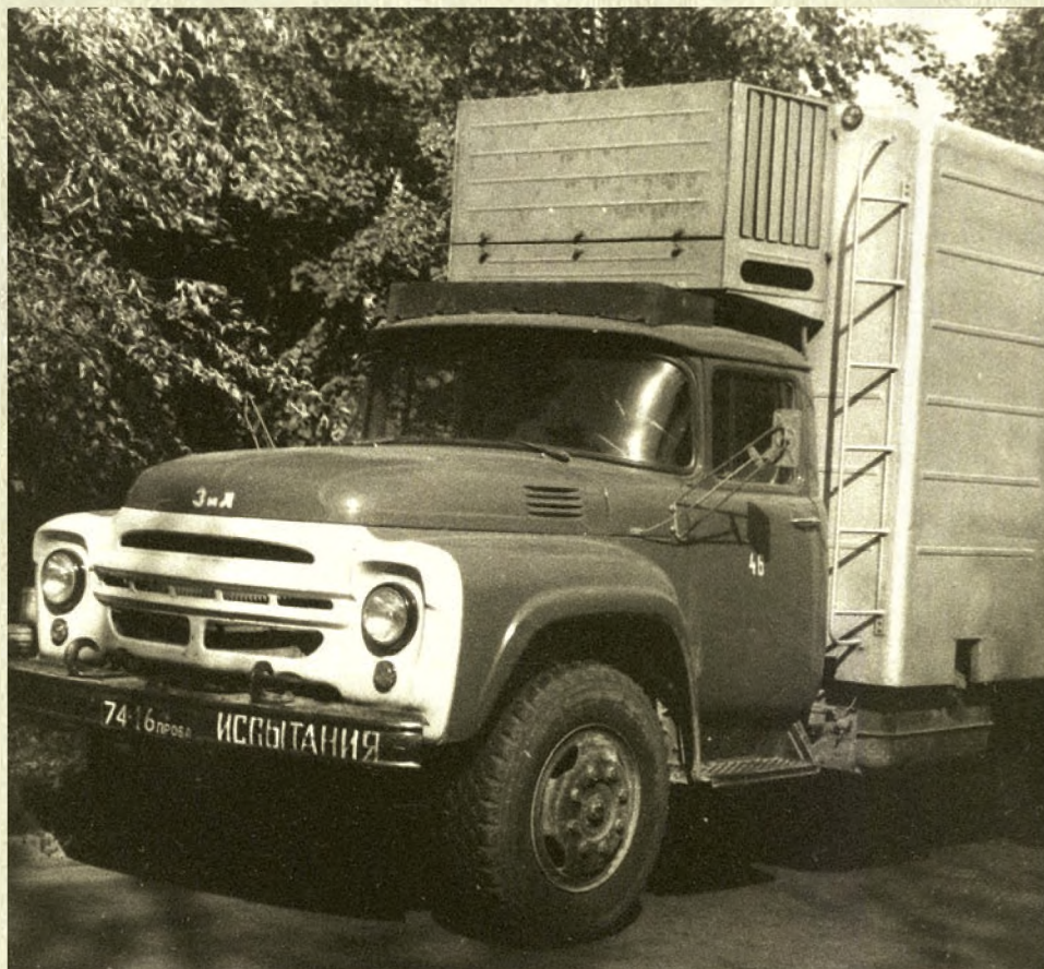
Опытный автомобиль-рефрижератор ЛуМЗ-4704 на шасси ЗИЛ-130, 1973 г.
