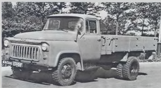
ГАЗ-56 второй серии с кабиной ГАЗ-53. Длина автомобиля – 5350 мм, база – 3000 мм
