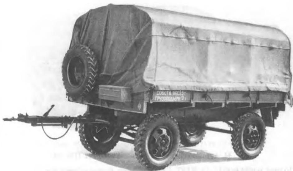
Рис. 33. Автомобильный прицеп СМЗ-710В (2-ПН-2)
