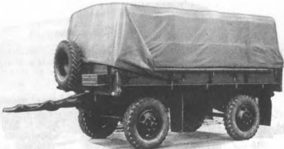
Рис. 34. Автомобильный прицеп СМ3-8325 (2-ПН-2М)
