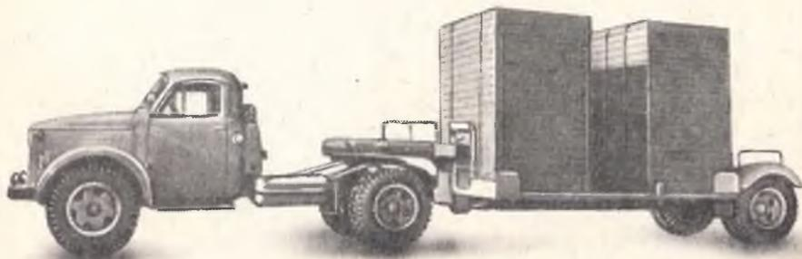
Полуприцеп-контейнеровоз А402 в сцепе с автомобилем-тягачом ГАЗ-51П
