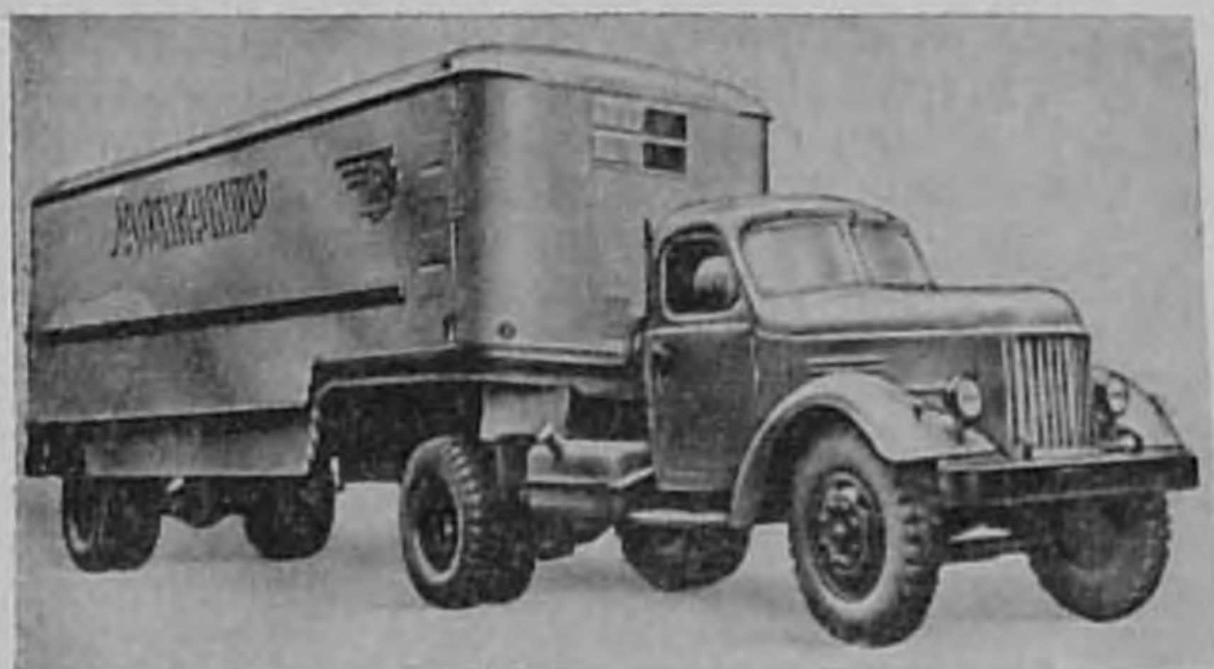
Фиг. 98. Автопоезд с полуприцепом-рефрижератором ОАЗ-826.
