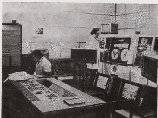
Рис. 6. Видеомагнитофоны «Кадр-5» и пульт автоматического электронного монтажа
