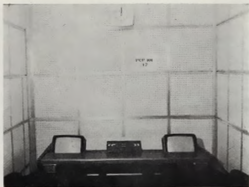
Рис. 9. Комментаторское место блока комментариев с экрана кинескопа
