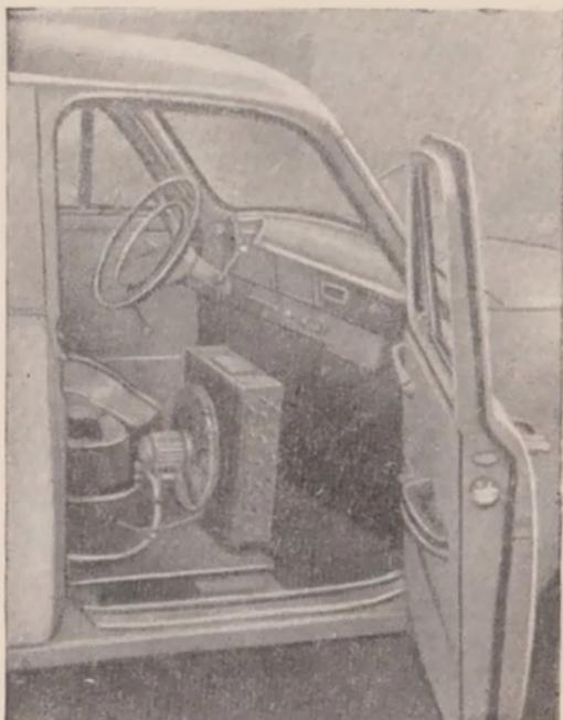
Рис. 10. Расположение холодильных агрегатов в автомобиле-рефрижераторе
