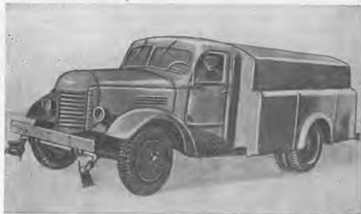
Рис. 15. Поливочно-моечная машина ПМ-8 на шасси автомобиля ЗИЛ-150.
