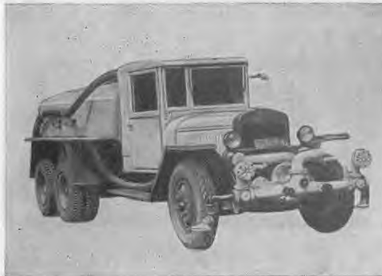
Рис. 17. Поливочно-моечная машина МПМ-2 на шасси автомобиля ЗИЛ-5.
