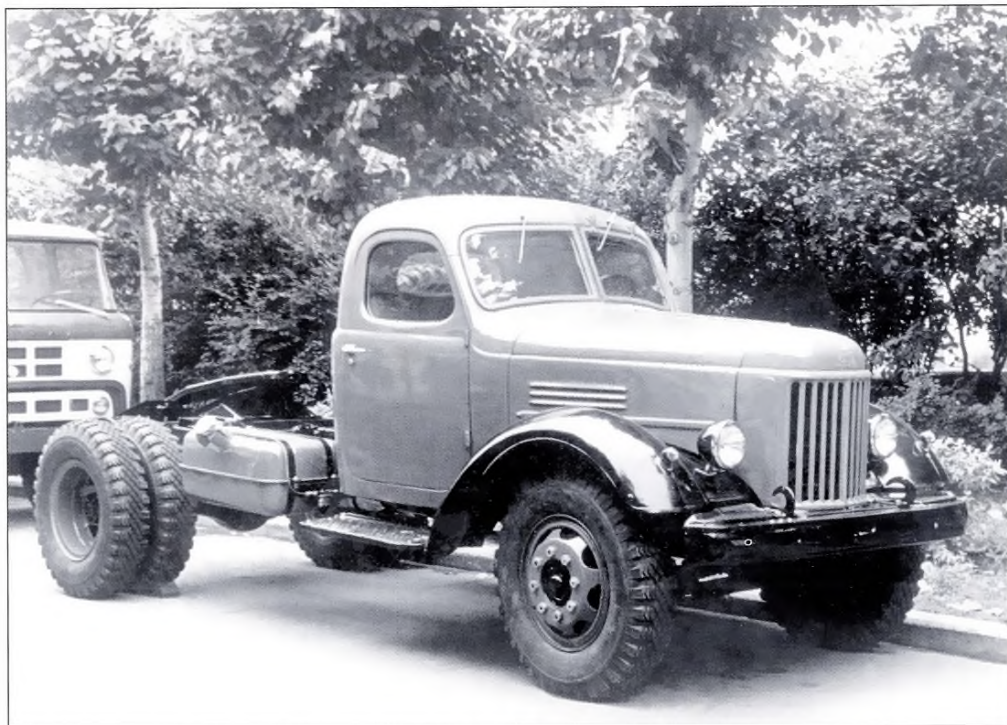
▲ Седельный тягач КАЗ-120Т3 на ВДНХ СССР. Бензобак с правой стороны присутствует, а выведенной вперед системы вывода выхлопных газов не видно. Двухцветная окраска (светлая кабина и темные крылья) характерна для автомобилей Кутаисского автозавода 1959-1960 гг. Фото из архива А. Исаева
