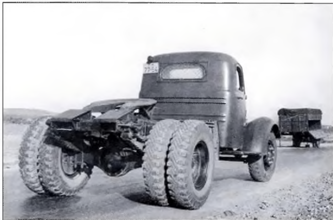
У некоторых серийных машин отсутствовал дополнительный бензобак с правой стороны автомобиля
