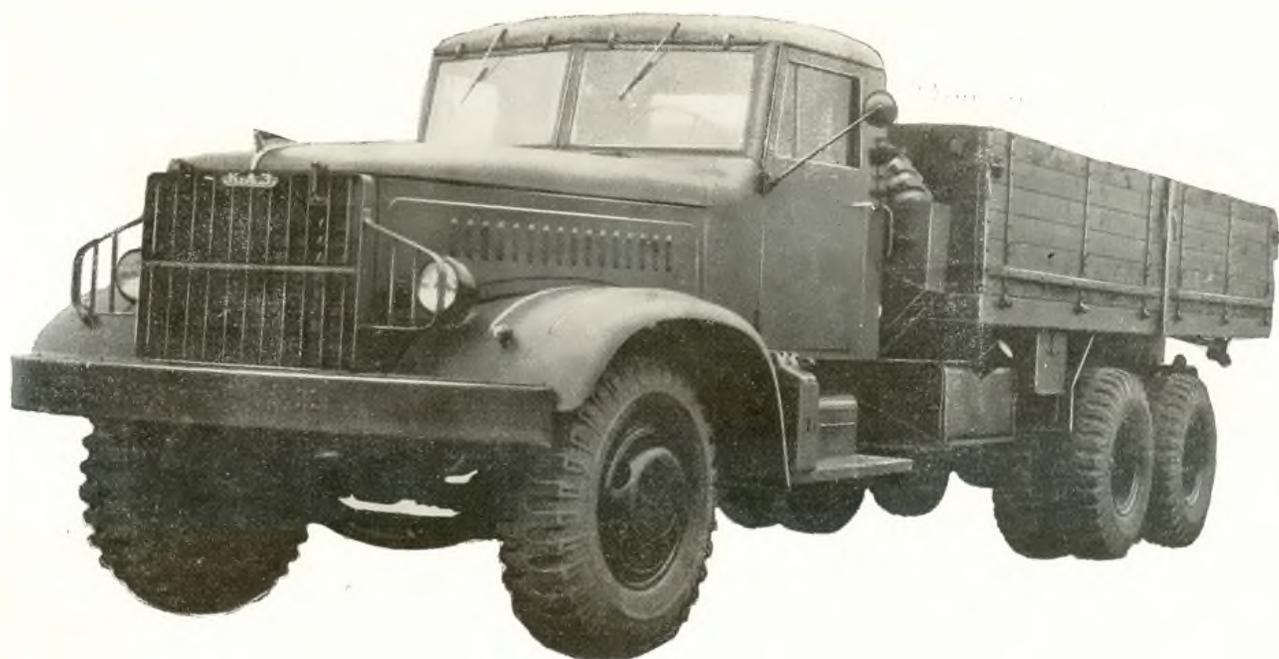
Тяжелый грузовой автомобиль предназначен для массовых перевозок грузов по дорогам с твердым покрытием. Автомобиль может буксировать прицепы общетранспортного назначения и прицепы-тяжеловозы, оборудованные тормозами с пневматическим приводом, общим весом 15000 кг. Завод выпускает следующие модификации: КрАЗ-221 — седельный тягач и КрАЗ-222 — самосвал.
