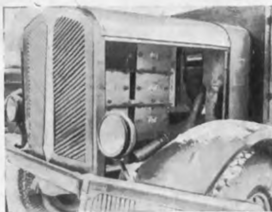
Рис. 2. Расположение силового реостата грузового троллейбуса
