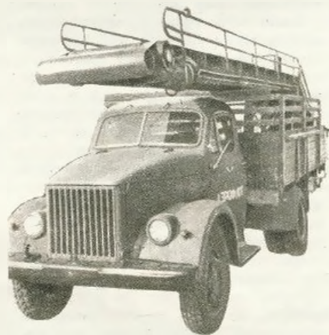
Автоконвейер АК-3 в транспортном положении.
