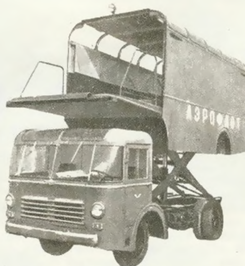
Автолифт АЛ-1 в транспортном и рабочем положении.
