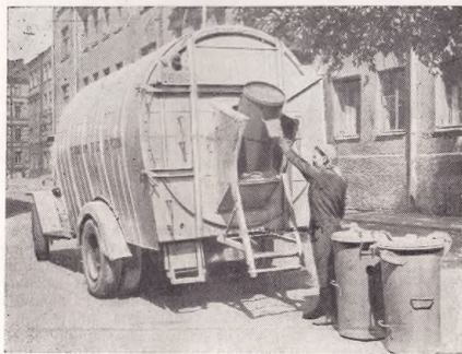
Рис. 23. Вторая стадия разгрузки мусоросборника в кузов мусоровоза МВ-10.
