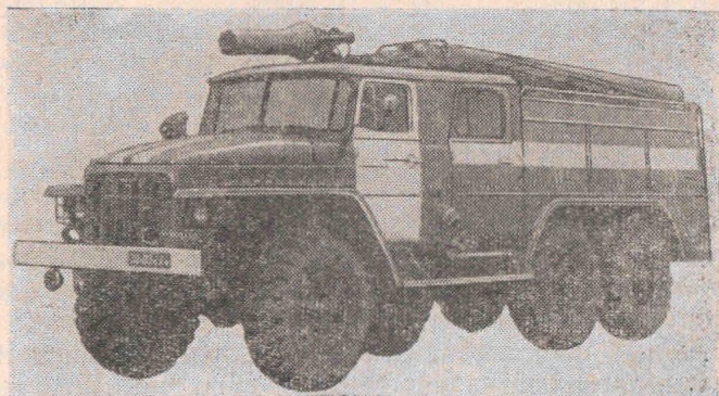
Рис. 1. Автоцистерна пожарная АЦ-40(375Н) Ц1А, модель ПМ-102А
