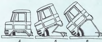
Рис. 1. Откидывающаяся кабина: а) рабочее положение; б) откидывание началось; в) кабина откинута.
