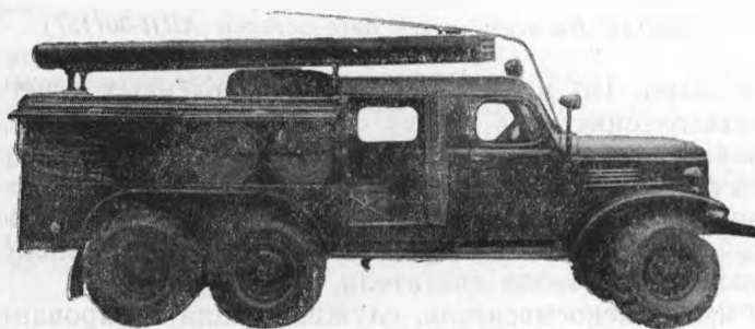
Рис. 12. Размещение противопожарного оборудования на автоцистерне АЦП-30(157). Вид справа
