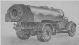
Фиг. 1. Подметально-уборочная машина У-10 на базе автомобиля ЗИЛ-130.
