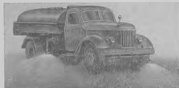
Фиг. 2. Подметально-уборочная машина У-10 на базе автомобиля ЗИЛ-130.
