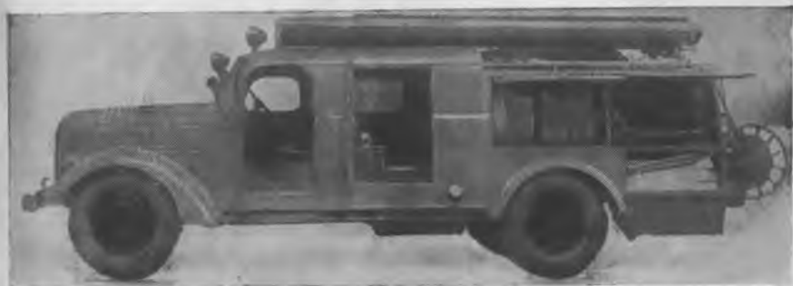
Рис. 16. Вид автонасоса с открытыми дверями (левая сторона).
