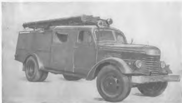
Рис. 32. Общий вид автоцистерны АЦ-30(150,164)-17.
