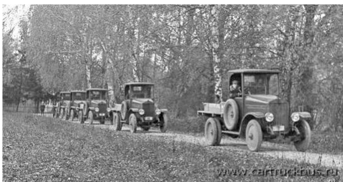
Пробный заводской выезд АМО-Ф-15 с полужакрытыми кабинами (подготовка к производству 2-й серии модели, 1926 г.) ( http://www.cartruckbus.ru/articles/ amo-f15-znakomiy-i-neznakomiy )
