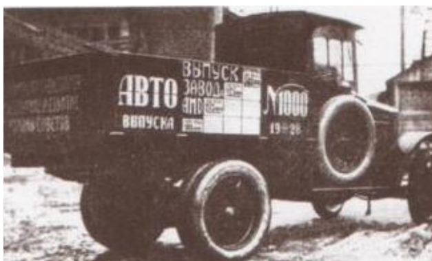
АМО-Ф-15 № 1000 (1928 г., 2-я серия) с жесткой полужакрытой кабиной, электрическими фарами и стартером. Фото из книги Л.Шугурова, 2004.
