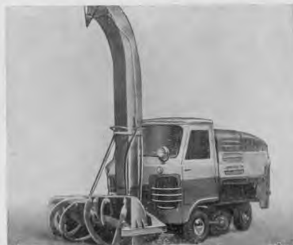
Фиг. 17. Машина ТУМ-479 для уборки тротуаров со шнеко-роторным оборудованием и направляющим кожухом для погрузки снега в транспорт.
