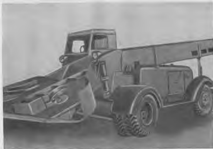
Рис. 27. Снегопогрузчик Т-105 на шасси автомобиля ЗИЛ-150.
