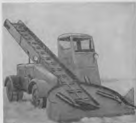
Рис. 28. Снегопогрузчик С-4 на шасси автомобиля ГАЗ-51.
