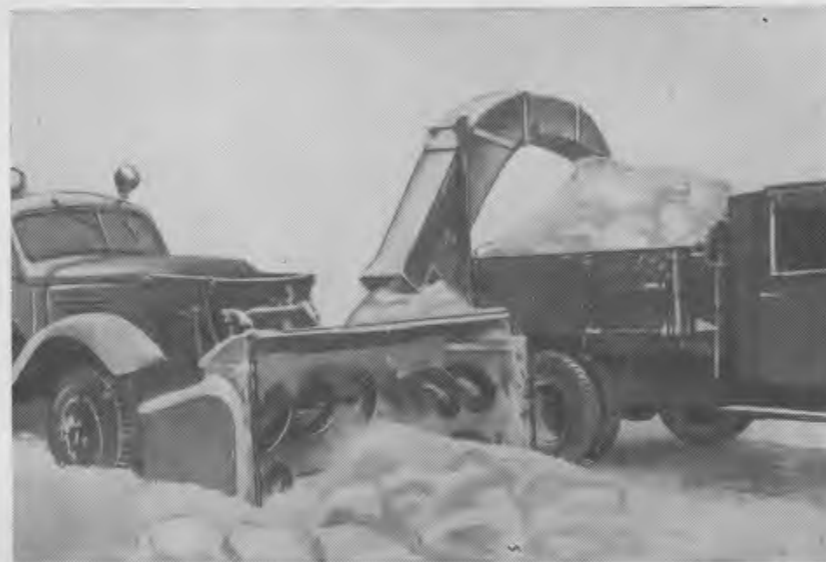
Рис. 33. Шнеко-роторный снегоочиститель на погрузке снега в кузов автомобиля.
