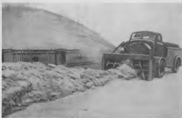
Рис. 32. Шнеко-роторный снегоочиститель на сбрасывании снега в реку.
