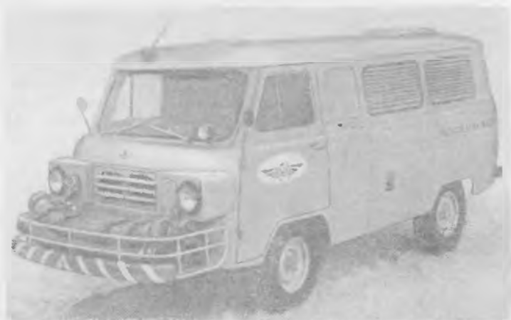
Рис. 96. Установка воздушного запуска УВЗ-2
