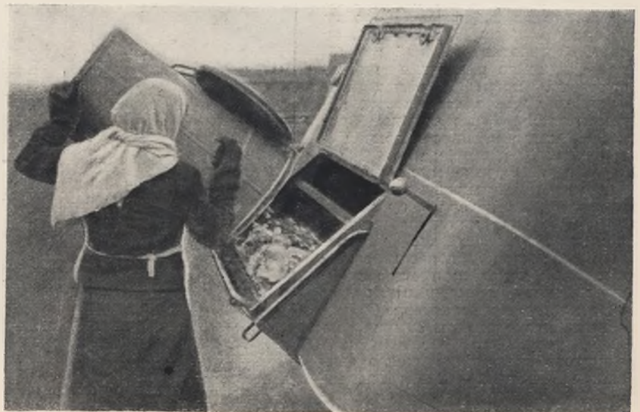
Рис. 3. Опорожнение мусоросборника в загрузочный люк мусоровоза «МС-2».
