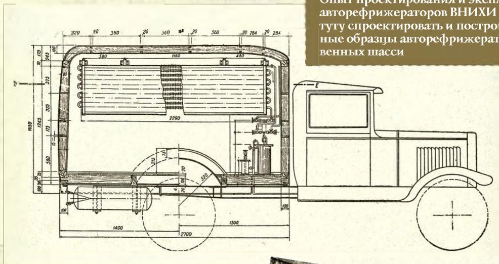
Продольный чертеж автомобиля-рефрижератора на шасси ГАЗ-АА с пропан-бутановым охлаждением, 1938 г.
