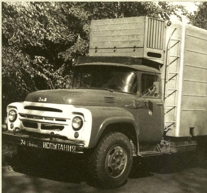
Опытный автомобиль-рефрижератор ЛуМЗ-470А на шасси ЗИЛ-130, 1973 г.
