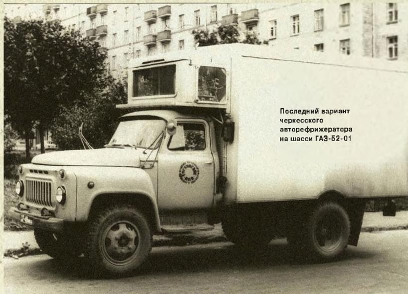
Последний вариант черкесского авторефрижератора на шасси ГАЗ-52-01
