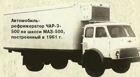
Автомобиль-рефрижератор ЧАР-3-500 на шасси МАЗ-500, построенный в 1961 г.
